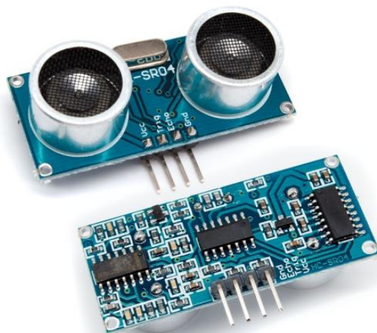
Сурет 2. HC-SR04 ультрадыбыстық датчигі
